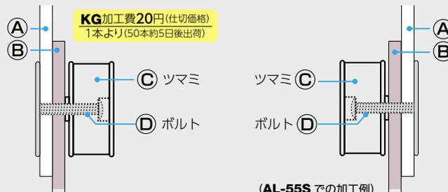
◎ボルト先端を潰してかしめ加工をし、バラバラにならないようにします。
