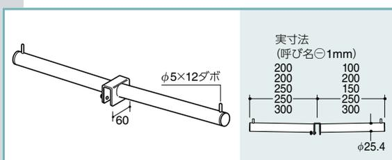
V-FW-19-1507 等と品番欄にご指定頂ければ下図のとおり (この場合ビス側 150mm 反対側 70mm) に別寸加工いたします。但し 10mm 刻み・片側最低寸法 60mm まで。なお誤手配防止のためサイズ欄にも基となる製品の呼び名 (この場合 2020) も必ずご記入ください。
