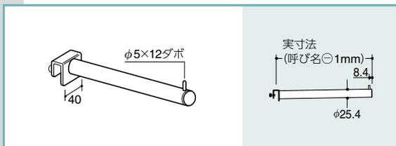
V-FS-19-230 などと品番欄にご希望サイズもご指定頂ければ下図寸法のとおりに別寸加工いたします。但し最低寸法 60mm まで。なお誤手配防止のためサイズ欄には基となる製品のサイズ (この場合 250) も必ずご記入ください。
