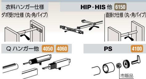
柱ダボはベッカータイプサポートには使用できません。またネジ式(ELSC-12など)に限りPSF・HSFサポートに装着する事は可能ですが、安全目安重量のDATAは適用されませんのでご注意ください。
