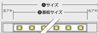
$(A \text{ サイズ} - B \text{ 基板サイズ}) \div 2 = \text{片側アキ寸法}$
