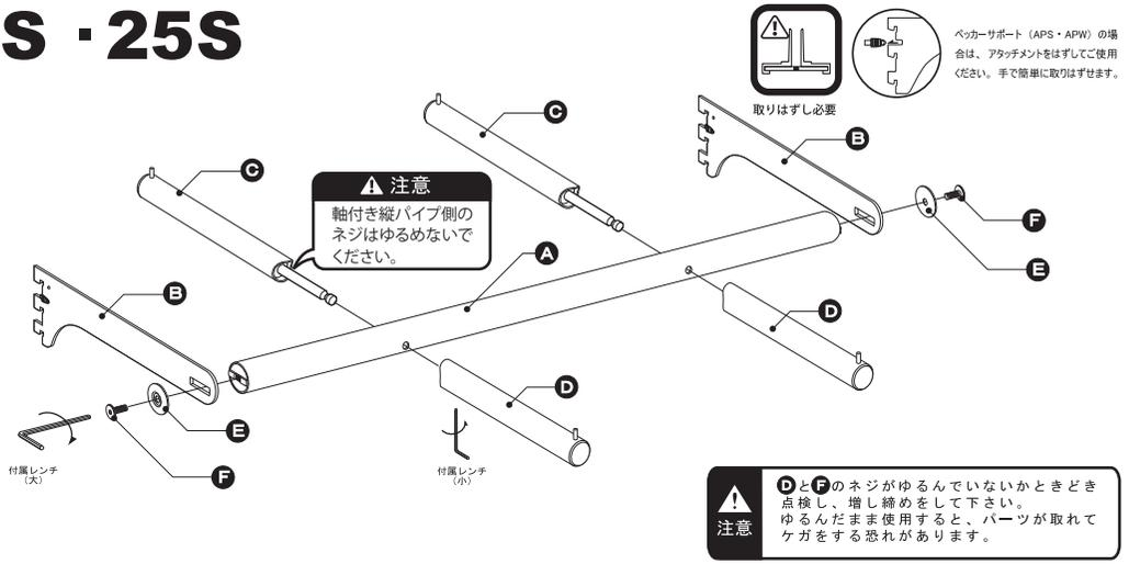
**注意** DとFのネジがゆるんでいないかときどき点検し、増し締めをして下さい。
